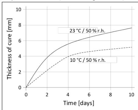
Diagramma 1: Velocità di indurimento per Sikaflex®-521 UV
